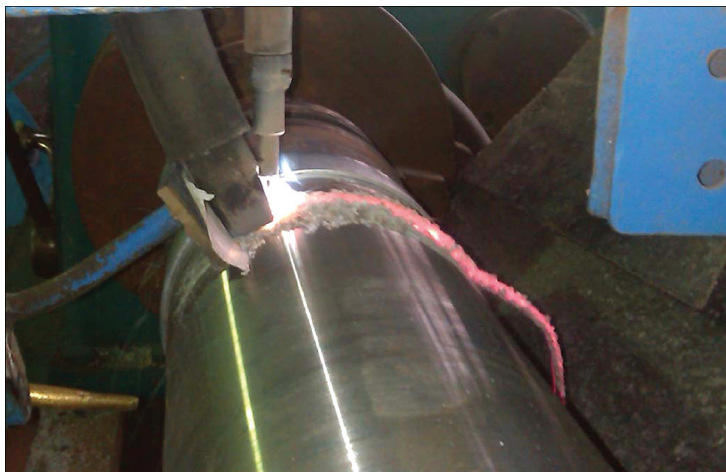
Рис. 1. Процесс наплавки штока
