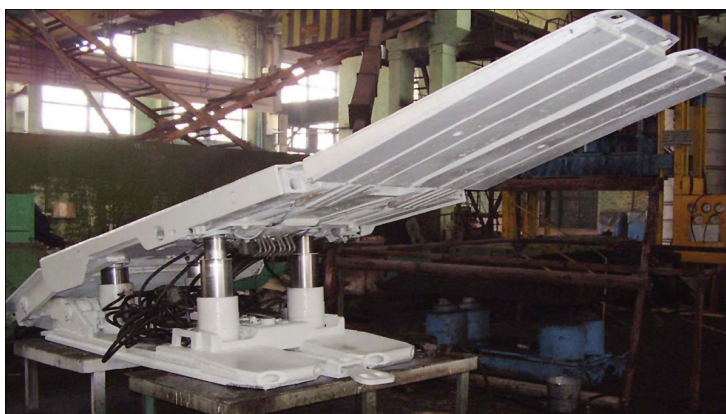
Рис. 2. Крепи механизированные после капитального ремонта
