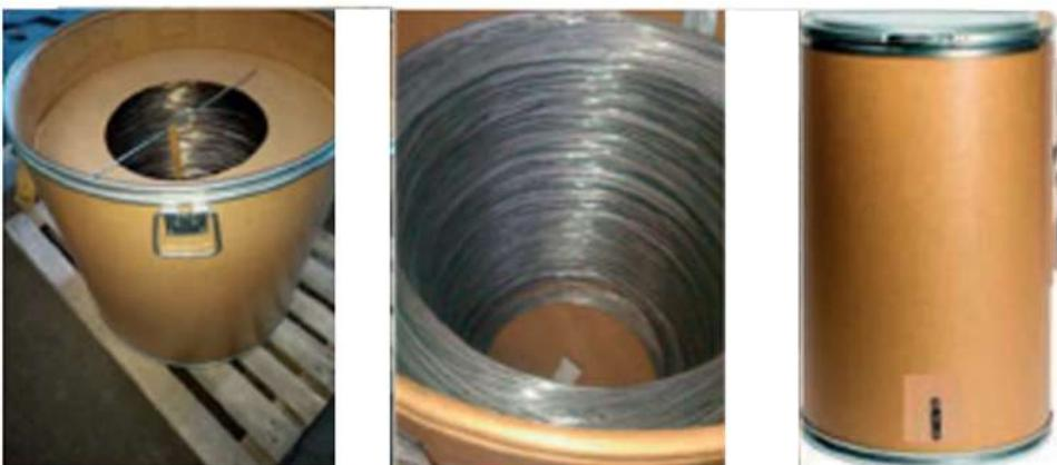
**2. ФОРМОВАННЫЕ МОТКИ БЕСКАРКАСНОГО ТИПА ИЛИ КАССЕТ С450
