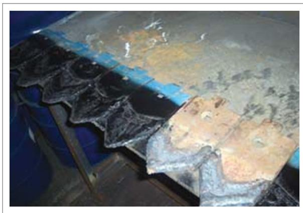
Рис. 2. Долота сеялки, наплавленные порошковой проволокой Велтек-Н634
