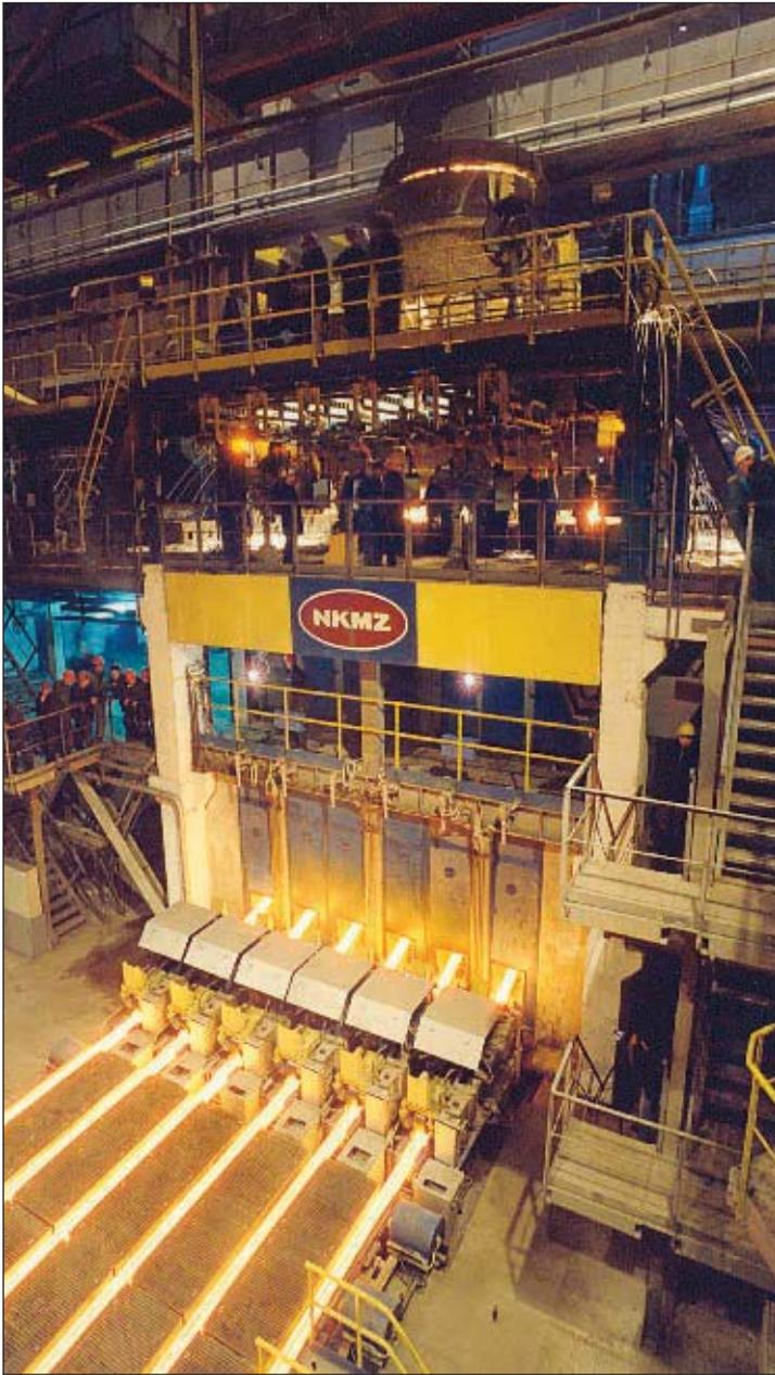
Рис. 2. Шестиручьевая сортовая машина непрерывного литья заготовок
