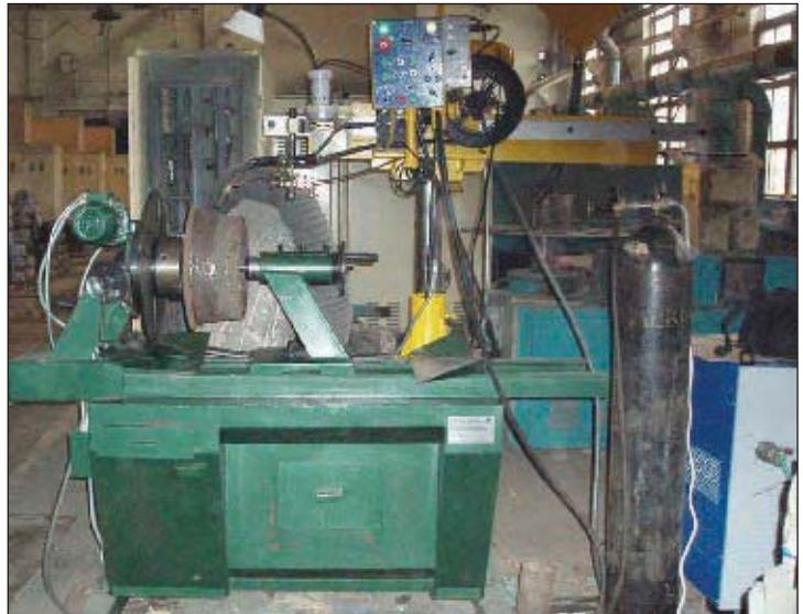
Рис. 5. Наплавка барабана волоочильного стана на установке ИЗРМ-5
