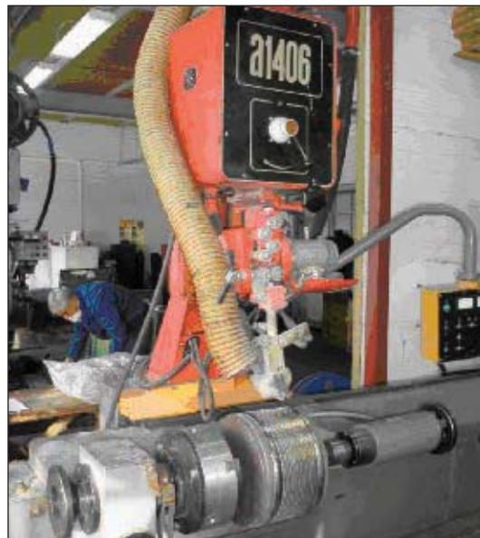
Рис. 3. Установка наплавки валков центрифуг
