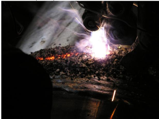
Широко застосовують для капітального ремонту кріплень вітчизняного і зарубіжного виробництва порошковий дріт «Велтек-Н425» діаметром 2,0 факхівці ЗАТ «НВП Спецвуглемаш» (м. Горлівка), наплавляючи ним циліндричні робочі поверхні стійок-домкратів діаметром 60-300 мм. Ви-
