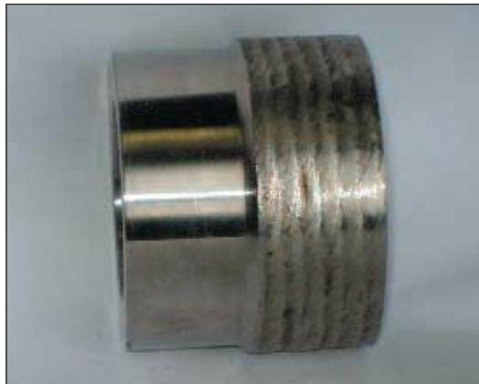
Рис. 2. Внешний вид поверхности наплавленного плунжера
