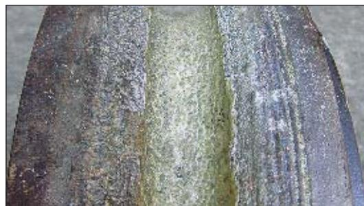
Рис. 2. Характерный износ поверхности третьего вала
