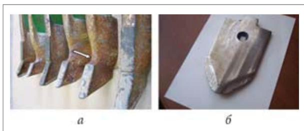
Рис. 1. Изношенные долота сеялки (а) и культиватора (б)
