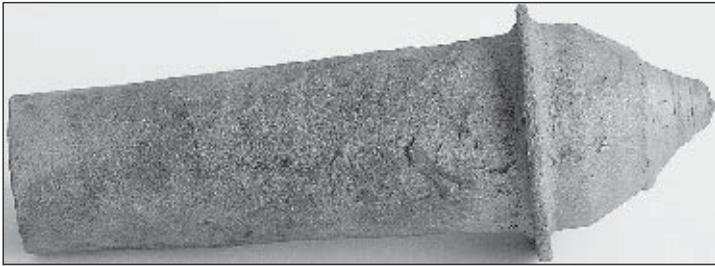
Рисунок. Керн клещевого крана, наплавленный самозащитной порошковой проволокой ВЕЛТЕК-Н480С
