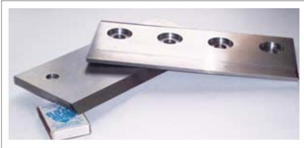
Рис. 3. Ножи установки ИДО-150, наплавленные порошковой проволокой Велтек-Н565
