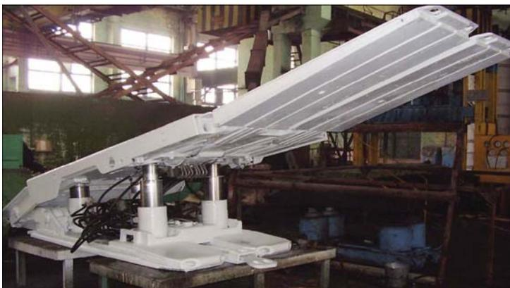
Рис. 2. Крепи механизированные после капитального ремонта
