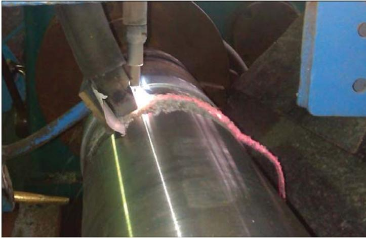
Рис. 1. Процесс наплавки штока
