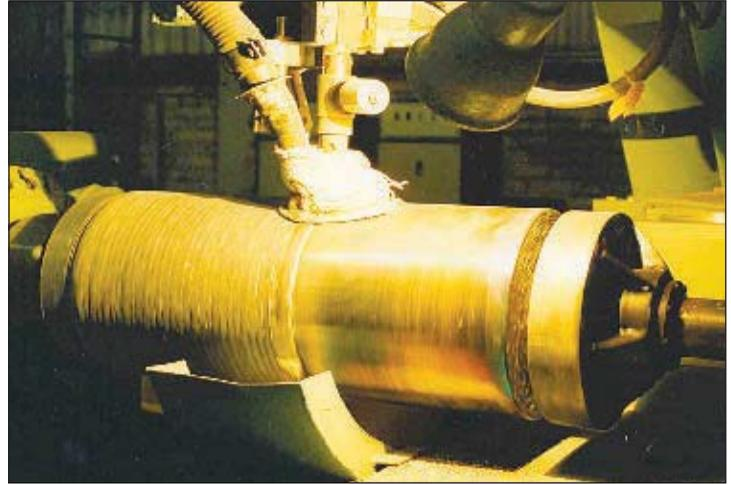
Рис. 1. Наплавка ролика МНЛЗ
