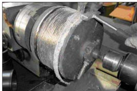
Рис. 4. Рабочий момент наплавки вала
