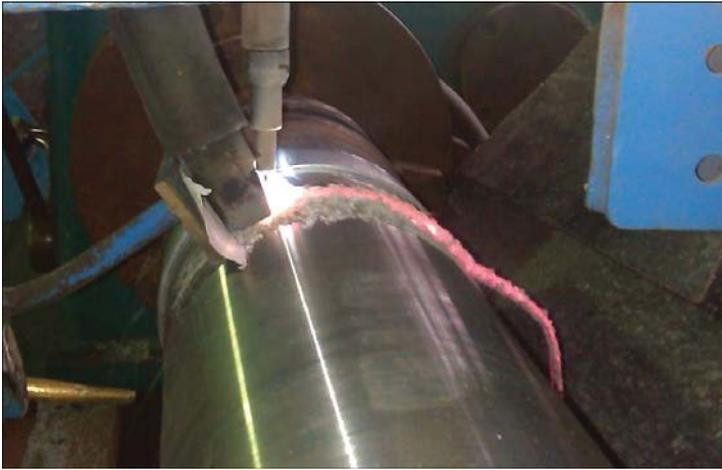
Рис. 1. Процесс наплавки штока
