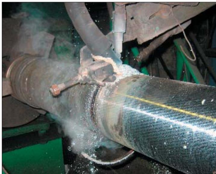
Рис. 3. Рабочий момент наплавки плунжера
