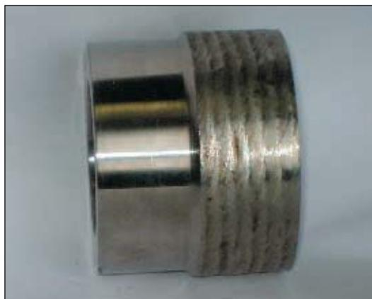
Рис. 2. Внешний вид поверхности наплавленного плунжера
