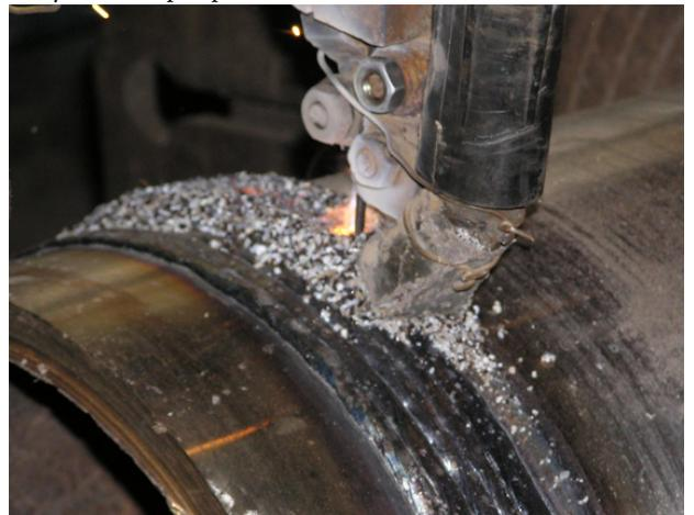
ТОВ «ТМ.ВЕЛТЕК» спільно з підприємством ЗАТ «Відновлення» впровадили на Вискунському металургійному комбінаті технологію ремонту правильних роликів із застосуванням багатошарового наплавлення, яке забезпечує твердість робочого шару в межах 62-65HRC.
