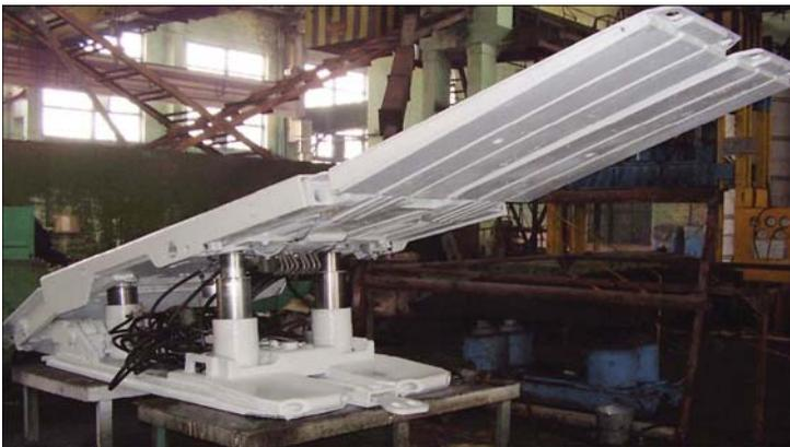
Рис. 2. Крепи механизированные после капитального ремонта
