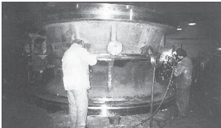
по горячему пневмоинструментом. Предварительный и сопутствующий подогревы выполняли четырьмя газовоздушными горелками. Температуру подогрева поддерживали в пределах 200–250 °С. Чашу сразу после сварки подвергли отпуску в печи при 560–600 °С. Выдержку определяли из расчета 3 мин на 1 мм толщины свариваемого металла. Остывание в печи проводили со скоростью 50 °С/ч до 100 °С с дальнейшим остыванием на воздухе.
